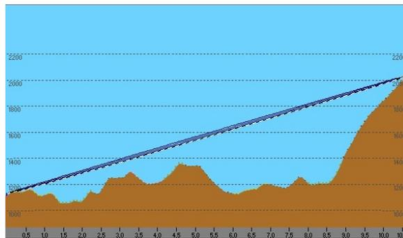
Figura 4.3: Perfil del terreno con Radio Mobile.
